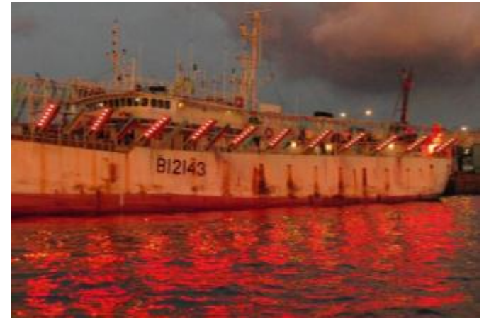
高功率綠能LED秋刀魚集魚燈具，整體耗油量節省20%，且漁獲量與傳統燈具相當。
